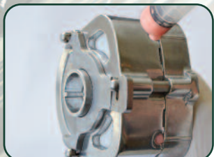
Iniezione resina Resin injection
