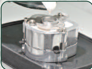
Colata di gesso nel coperchio per il controstampo / Plaster pouring in the flask
