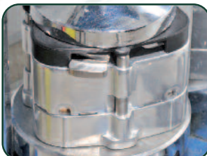
Chiusura muffola sotto la pressa Flask closure under press
