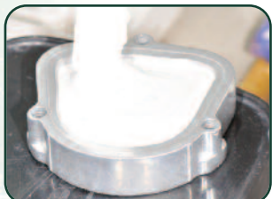
Colata gesso in base muffola utilizzata come boxaggio / Plaster pouring in flask base used as mold
