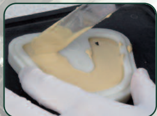
Colatura del gesso sul Tray Model casting in Tender Tray
